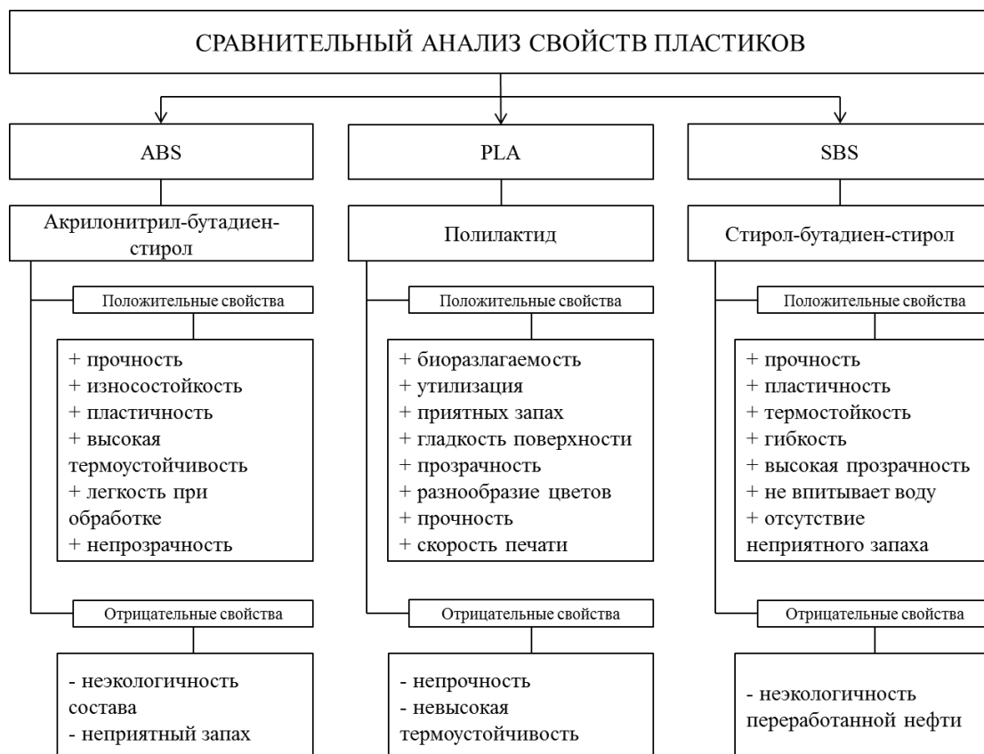
Рисунок 1 – Сравнительный анализ свойств пластиков для 3D-печати
