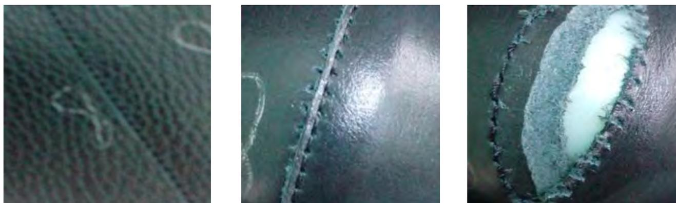
Рисунок 3 – Внешний вид однорядного настрочного шва при сострачивании образцов (игла KKS, шов без упрочнения):
