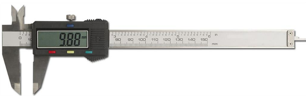
Рисунок 2 – Внешний вид штангенциркуля цифрового типа ШЦЦ-I-300В
