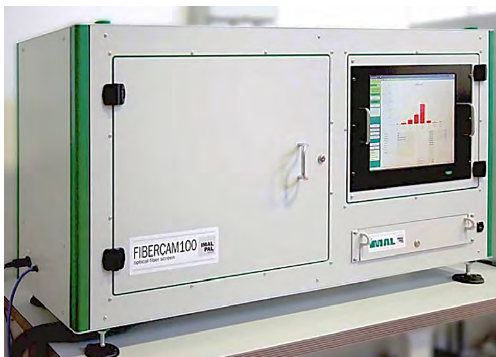
Рисунок 1 – Оптический сортировщик волокна FiberCam 100
