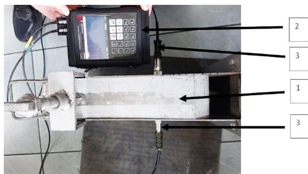
1 – установка АДУ; 2 – вибронализатор; 3 – преобразователи вибраций 1 – ADU installation; 2 – vibration analyzer; 3 – vibration
