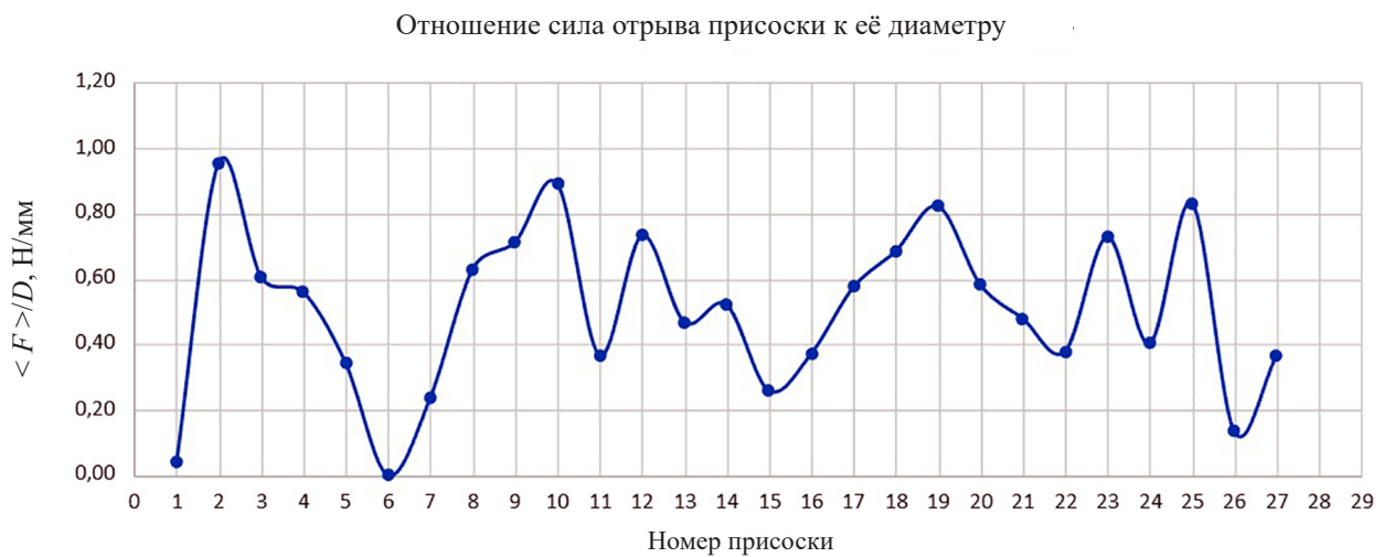
Рисунок 6 – Относительное усилие отрыва для испытанных присосок Figure 6 – Relative pull-off force for the tested suction cups
