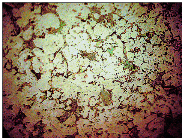
Рисунок 4 – Микроструктура карбидостали проявленная травителем № 2 после 9 минуты обработки
