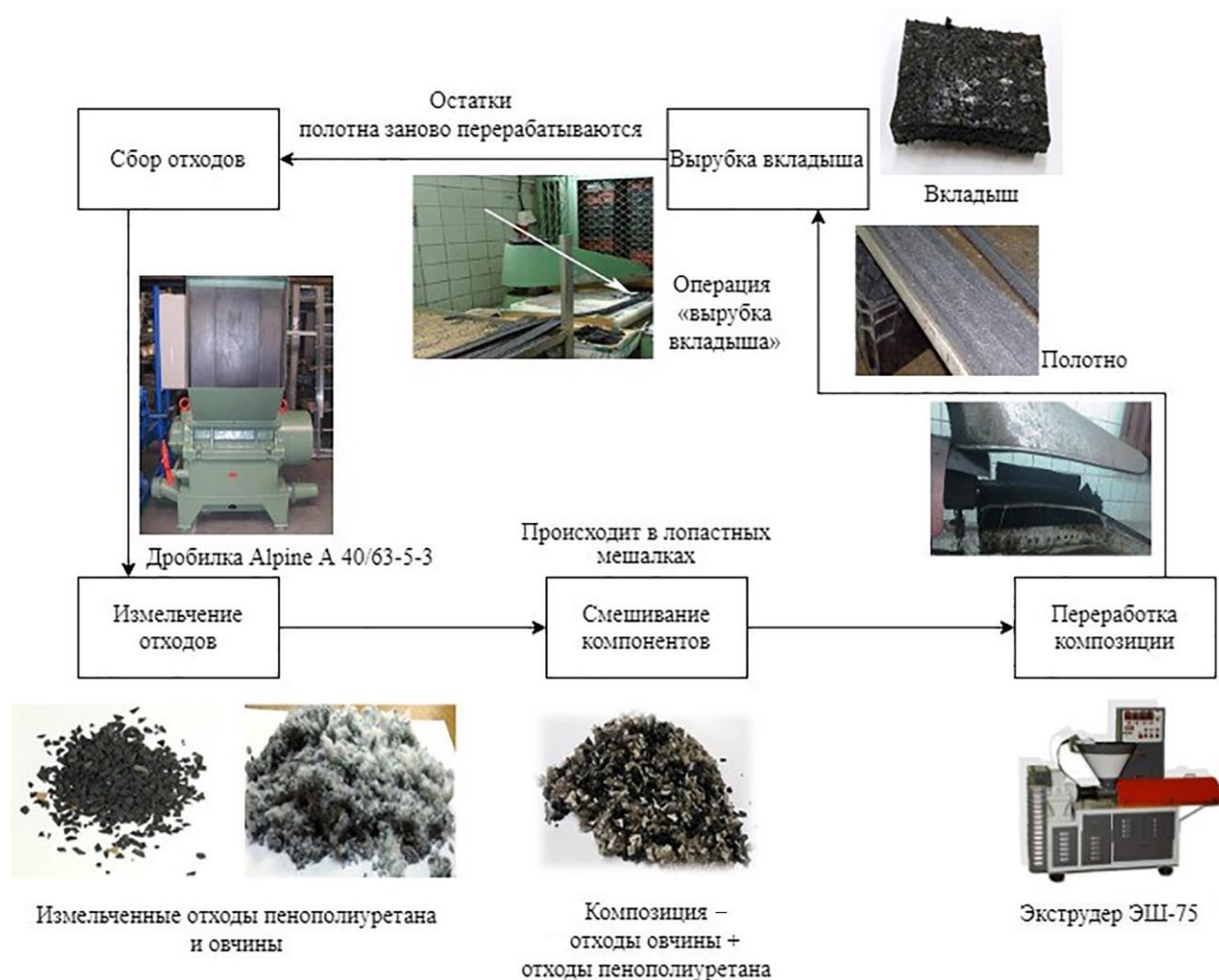
Рисунок 3 – Технология получения вкладыша для низа обуви
