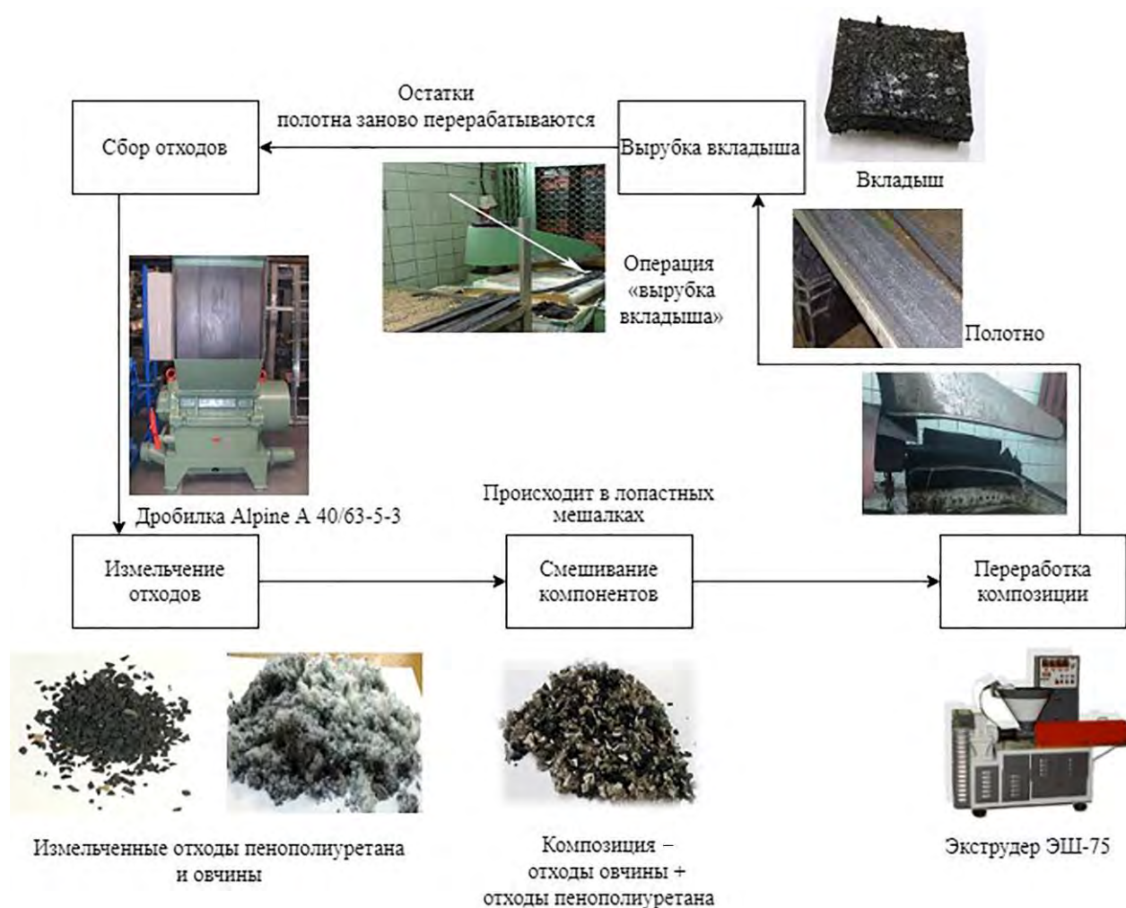
Рисунок 3 – Технология получения вкладыша для низа обуви
