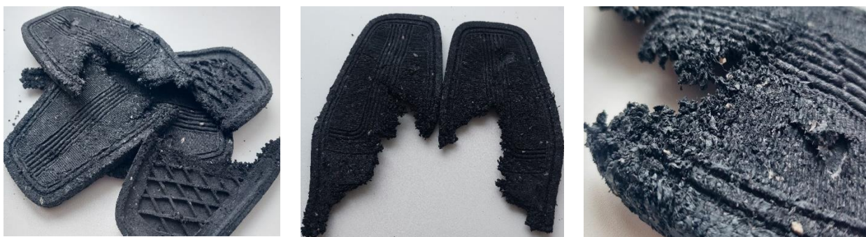
Рисунок 2 – Несформированные подошвы с волокнистым наполнителем более 6 мм
