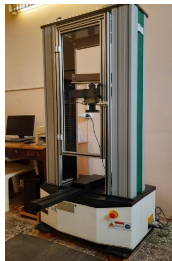
Рисунок 4 – Внешний вид универсальной испытательной машины MEITEISI WDW-50
