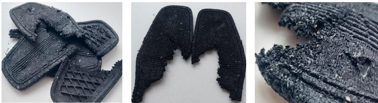
Рисунок 2 – Несформированные подошвы с волокнистым наполнителем более 6 мм
