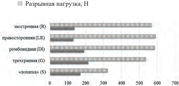
Рисунок 7 – Зависимость раздвигаемости нитей ткани в швах и разрывной нагрузки при использовании различных игл
