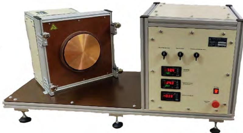
Рисунок 1 – Прибор для определения суммарного теплового сопротивления ткани SHR
