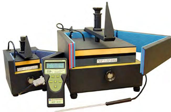
Рисунок 2 – Прибор для измерения коэффициента теплопроводности и термического сопротивления ИТП-МГ4
