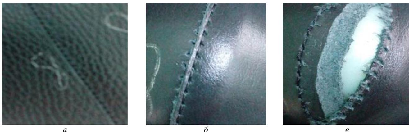
Рисунок 3 – Внешний вид однорядного настрочного шва при сострачивании образцов (игла KKS, шов без упрочнения):
