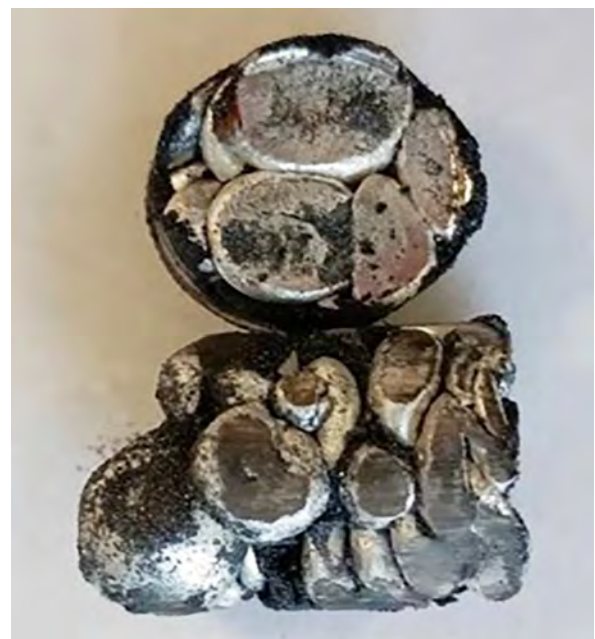
Рисунок 6 – Общий вид брикета после прессования Al-SiC
