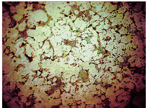
Рисунок 4 – Микроструктура карбидостали проявленная травителем № 2 после 9 минуты обработки
